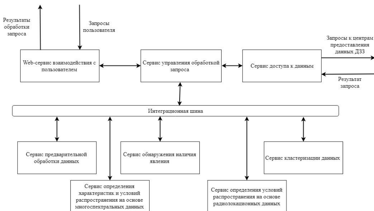
Рисунок 2 – Сервис-ориентированная архитектура Web-ориентированной системы мониторинга ОС с использованием данных ДЗЗ
